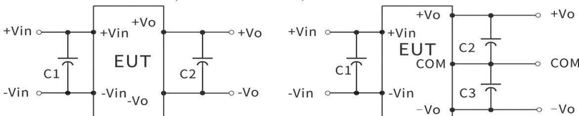
2、纹波&噪声测试: (双绞线法 20MHZ 带宽)
