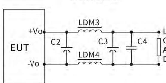
对纹波&噪声要求一般时，外围推荐仅使用 C2、C5 即可；对纹波&噪声要求严格时；推荐使用上图电路。
