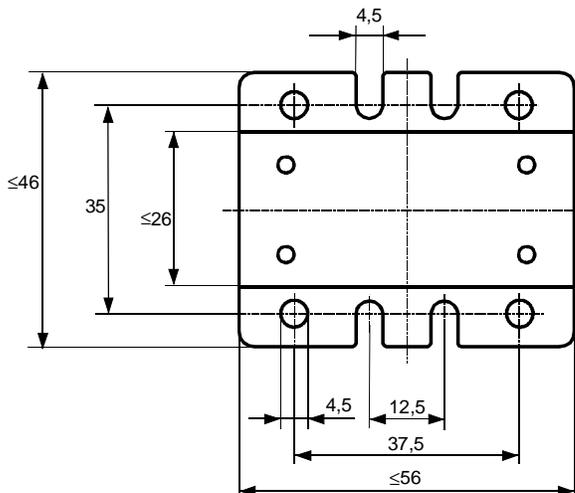
Toleranz der Befestigungsraster  $\pm 0,5\text{mm}$
