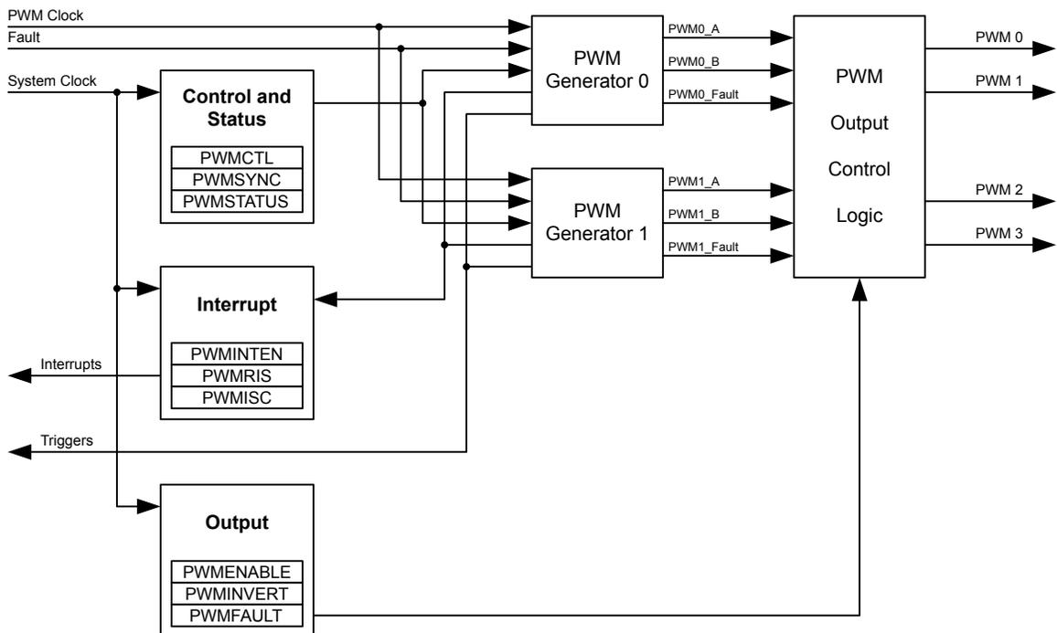
Figure 16-2. PWM Module Block Diagram
