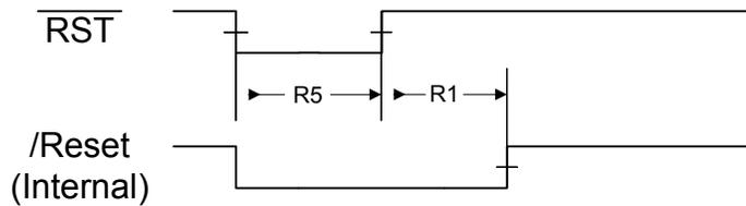
Figure 20-8. Software Reset Timing
