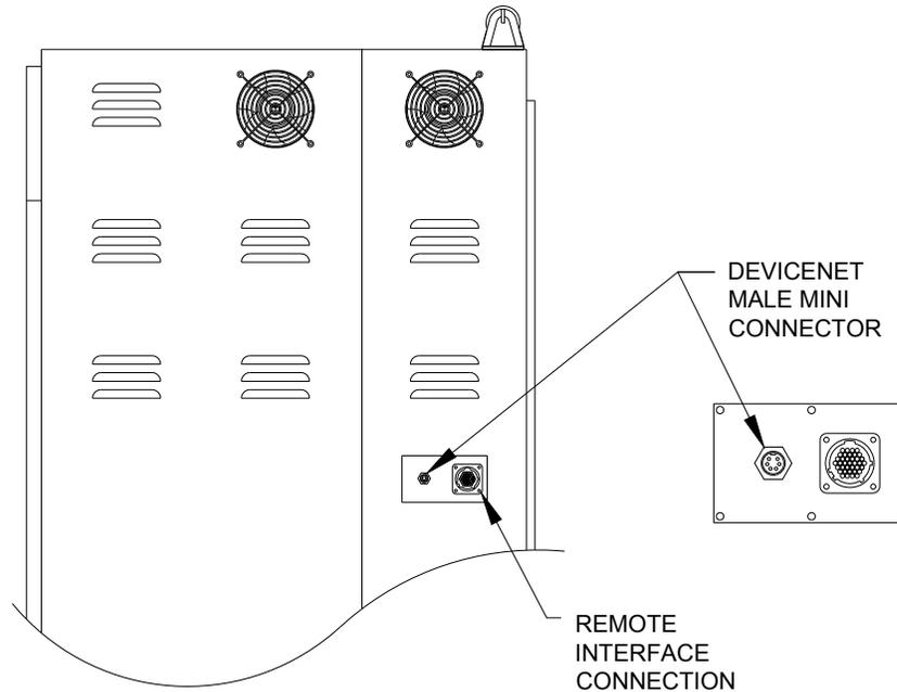
**Figure 41: DeviceNet male mini connector plug**
