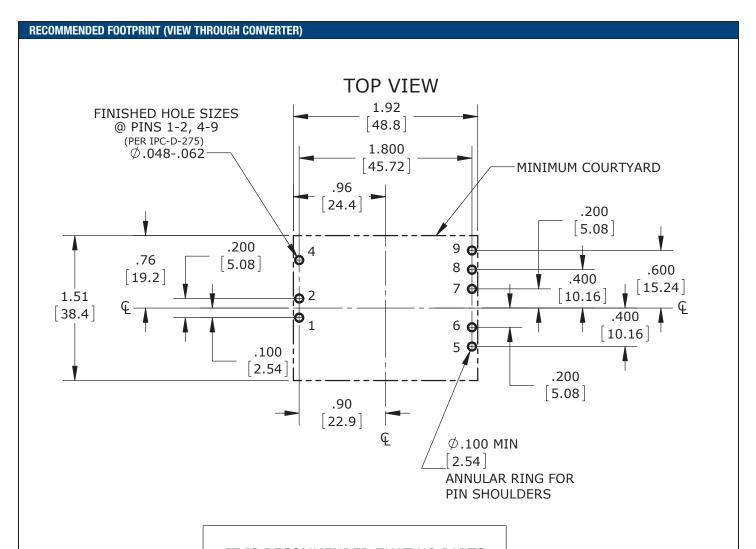
IT IS RECOMMENDED THAT NO PARTS BE PLACED BENEATH CONVERTER
