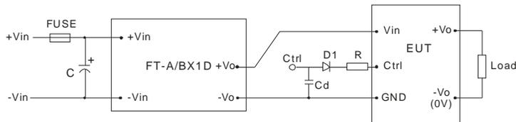
标称输入电压小于 48V 时,  $C \geq 330\mu\text{F}/50\text{V}$
