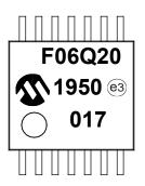
14-Lead SOIC (3.90 mm)
