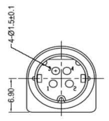
PIN2: +V PIN4:+V
