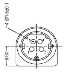
PIN2: +V PIN4:+V
