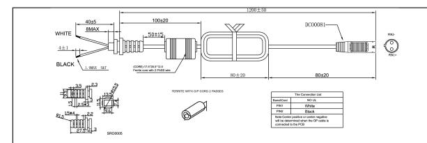
Cable type: NO UL 16AWG\*2C ROUND OD:5.5 mm
