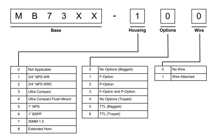
Active Part Numbers for MB7360 MB7360-100 MB7360-101 MB7360-110 MB7360-111 MB7360-120 MB7360-121 MB7360-130 MB7360-131 MB7360-200 MB7360-201 MB7360-210 MB7360-211 MB7360-220 MB7360-221 MB7360-230 MB7360-231 MB7360-500 MB7360-501 MB7360-510 MB7360-511 MB7360-520 MB7360-521 MB7360-530 MB7360-531 MB7360-600 MB7360-601 MB7360-610 MB7360-611 MB7360-620 MB7360-621 MB7360-630 MB7360-631 MB7360-700 MB7360-701 MB7360-710 MB7360-711 MB7360-720 MB7360-721 MB7360-730 MB7360-731
