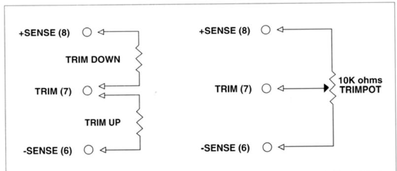
**Hinweis:** Soll External Output Trimming nicht benutzt werden bleibt der PIN unbeschaltet.
