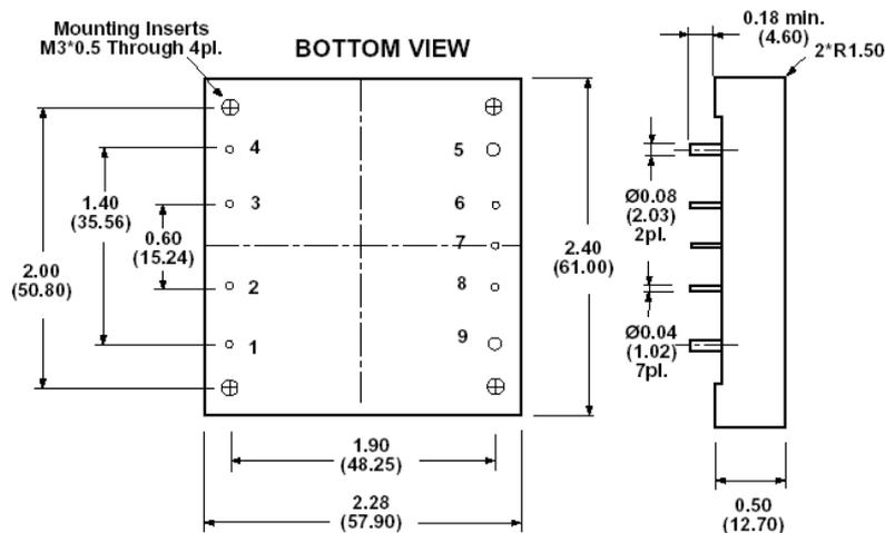
**Pin-Belegung/ pin assignment**
