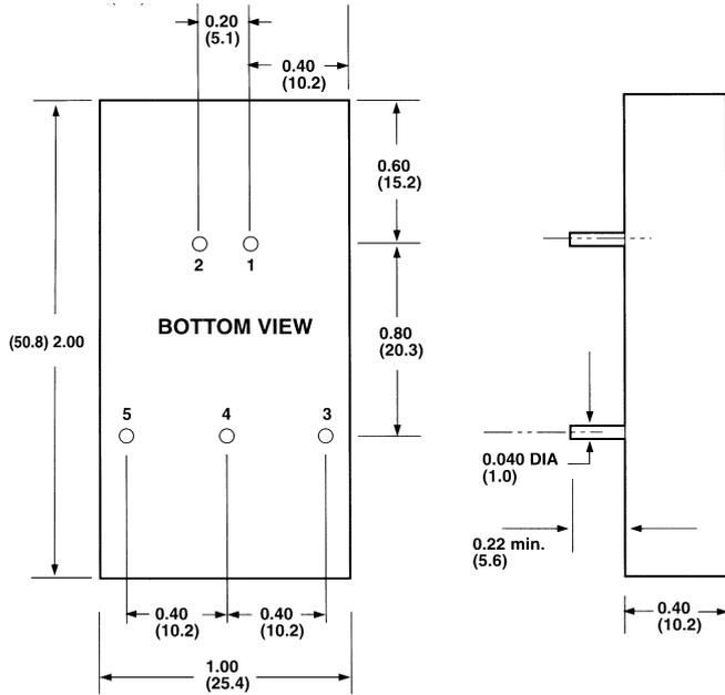
**Pin Belegung / Pin assignment**
