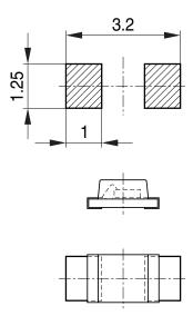
Bauteil positioniert Component location on pad OHFP2578
